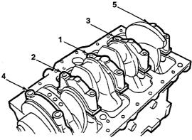
MAIN BEARING CAP TIGHTENING SEQUENCE
