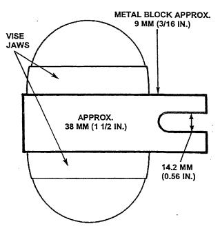
FIGURE 12. PINION STOP SUPPORT BLOCK
