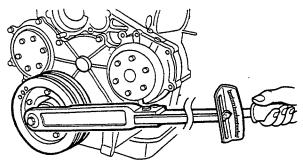
INSTALLING CRANKSHAFT PULLEY
