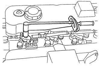
TORQUING THE FUEL INJECTOR HOLDER BRACKET
