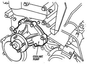
INSTALLING COOLANT PUMP
