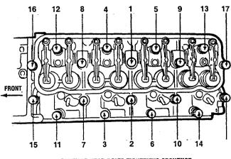
CYLINDER HEAD BOLTS TIGHTENING SEQUENCE
