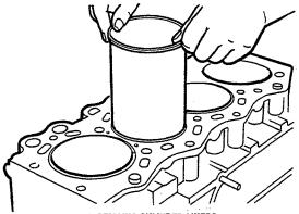
INSTALLING CYLINDER LINERS
